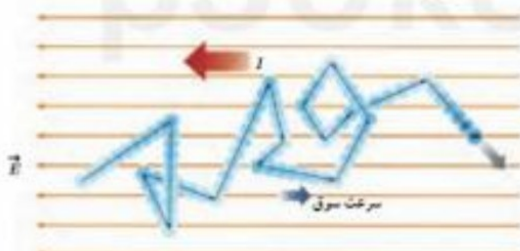
شکل ۷-۲ مسیر زیگزاگ یک الکترون آزاد در یک رسانای فلزی. در حضور میدان الکتریکی، این مسیر زیگزاگ در خلاف جهت میدان سوق یافته است.
