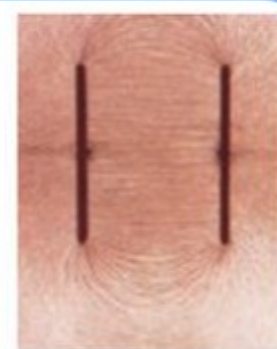
شکل ۱-۱۹ سمت‌گیری دانه‌ها در فضای بین دو الکتروده صفحه‌ای موازی
