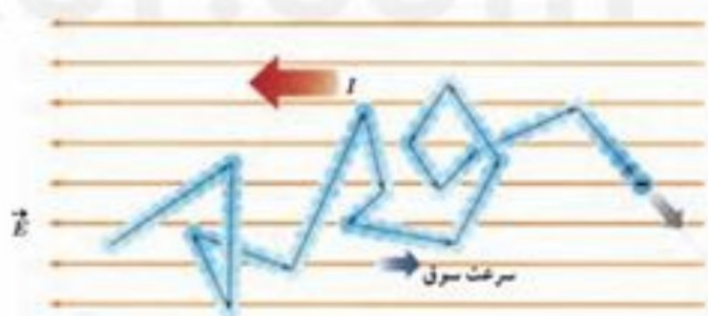
شکل ۷-۲ مسیر زیگزاگ یک الکترون آزاد در یک رسانای فلزی. در حضور میدان الکتریکی، این مسیر زیگزاگ در خلاف جهت میدان سوق یافته است.
